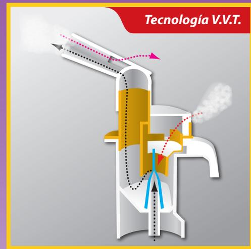
La boquilla permite la exhalación sin la válvula de silicona gracias a su excepcional estructura de salida de aerosol y exhalación.
